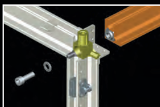
Detalhe canto desmontado
